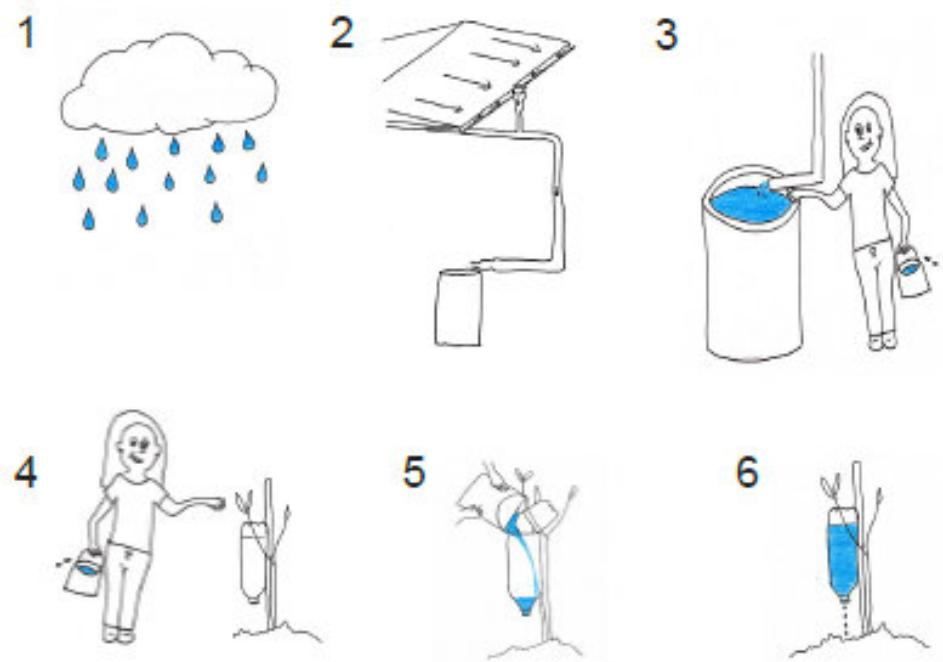
posteriormente a quem interessasse. (FIGURA 9). O teto da casinha de ferramenta estava adaptado para coleta de água e um sistema de irrigação “inteligente” foi criado. (FIGURA 10). Esse material foi sistematizado e entregue à população em forma de cartilha cuja ilustração está representada na Figura 11.
