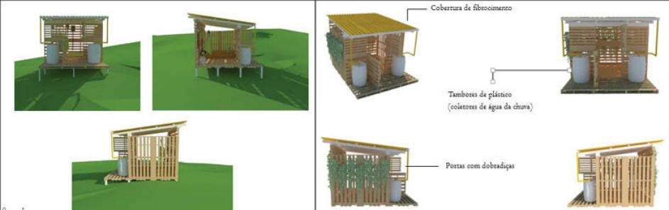
**Figura 10:** Projeto da casinha de ferramentas incluindo modo de construção, detalhamento da estrutura de captação de água e inserção prevista no terreno. Fonte: Produzido pelo grupo Gabriela Viana, Júlia Haddad, Luíza Melo e Rafaela Souza.
